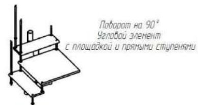
Схема расположения ступеней относительно опорных площадок металлического каркаса
