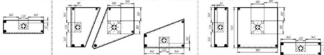
Разметка ступеней для засверливания под больца, болты крепления (отверстие \varnothing 9 мм) и стойки перил (отверстие \varnothing 26 мм)
